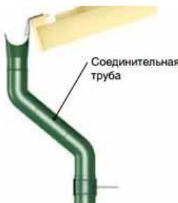
Выпускные воронки необходимо подсоединить к водосточной трубе. Для этого потребуется два колена и одна соединительная труба. Ее длина уточняется при монтаже, труба отпиливается до требуемого размера.
