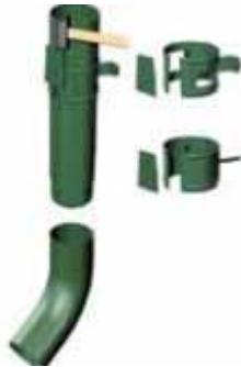
Держатели крепятся к несущей стене из расчета 1:1 (один держатель на каждый метр водосточной трубы и на стыке 2-х труб). Сама труба отрезается до заданной длины, вставляется в держатель и фиксируется замковым соединением.
