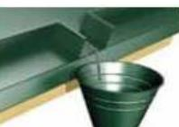
Для фальцевой крыши и кровель сложной конфигурации вместо желобов применяются водосборные воронки. Вставьте нижнюю часть воронки в верхнее колено водосточной трубы и закрепите конструкцию саморезами на карнизе.
